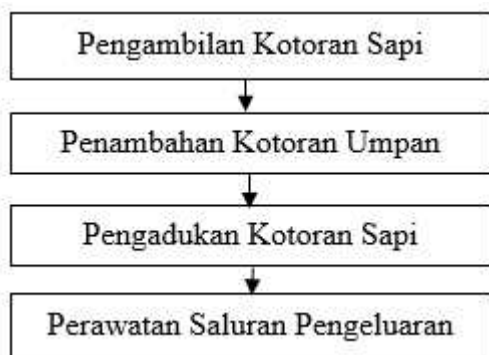
Gambar 1. Tahapan Proses Produksi Biogas di Kabupaten Lombok Barat
